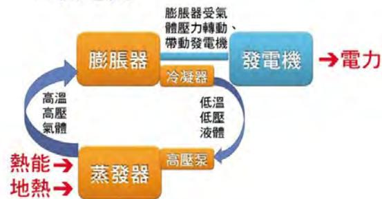
熱管地熱發電，只傳熱、不傳地下水，安全有保障
